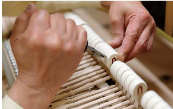
ピッカーと呼ばれる器具の針をハンマーフェルトに刺し、ほぐしていく整音の工程。そのピアノの音色を決める重要な作業だ。
