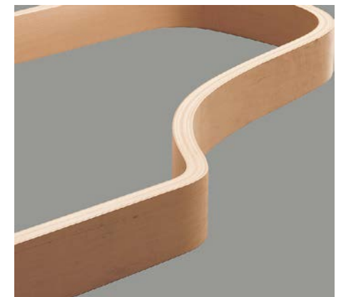
薄い木材を貼り合わせて厚みを作る曲線支柱。この上に響板が接着されるため、この造りが音の鳴りに大きく影響する。
